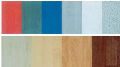
Hay superficies laminadas de muchos colores y diversos motivos. El material es a prueba de rupturas e impactos, con un alto grado de resistencia al fuego y a las manchas y fácil de limpiar.
